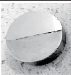
▲ 純ニッケルへの電気メッキに成功した（円形材料の上部分がクロムメッキ）
